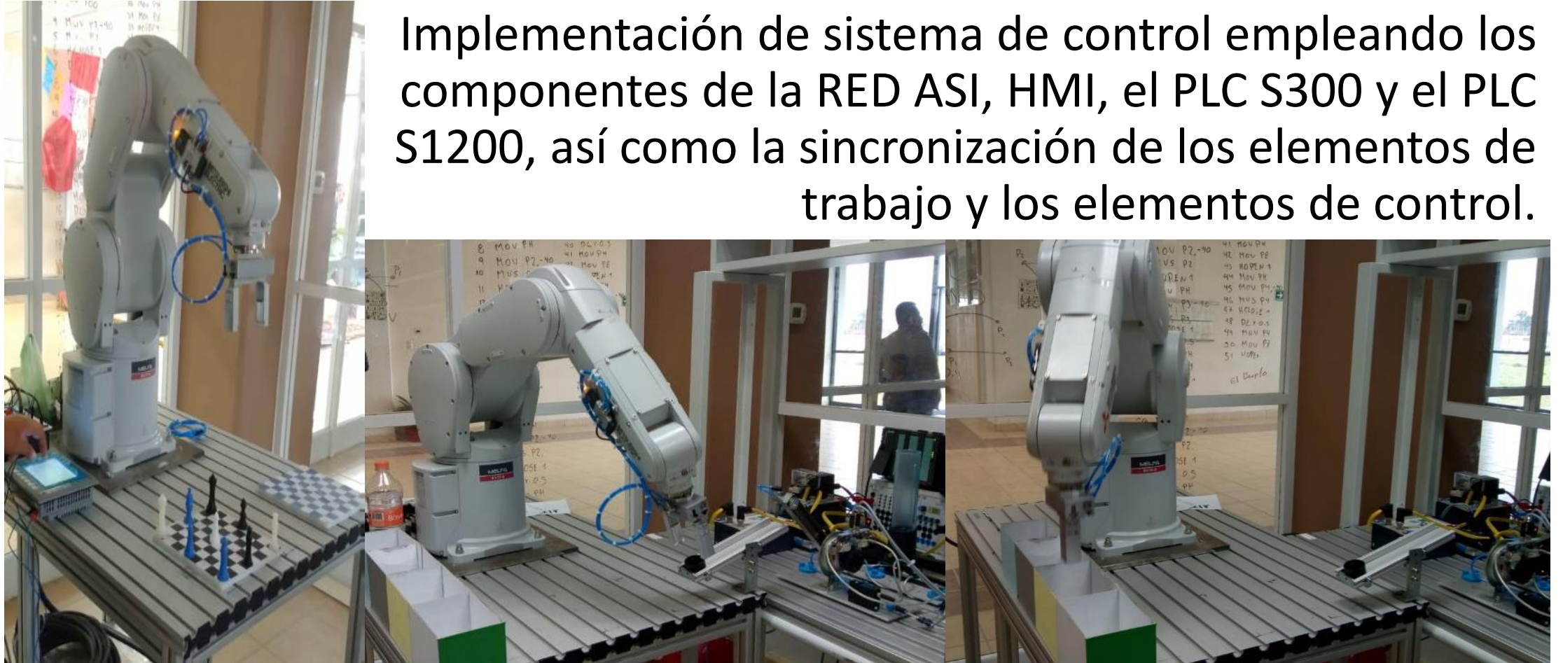
Figura 9. Clasificación de piezas, una vez que el Robot sabe el color de la pieza de trabajo se clasifica en las posiciones asignadas
