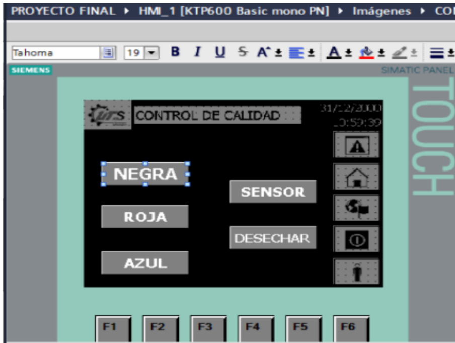
Figura 5. Pantalla HMI para el monitoreo de arranque del sensor y la variable detectada por el mismo. (izquierda) simulación, (derecha) implementación.
