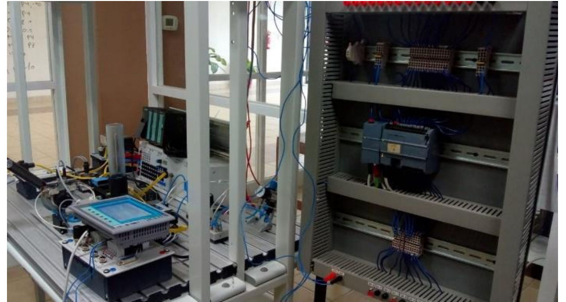
Figura 7. Comunicación Pantalla HMI y PLC S1200, pruebas de forzado de variables de salida
