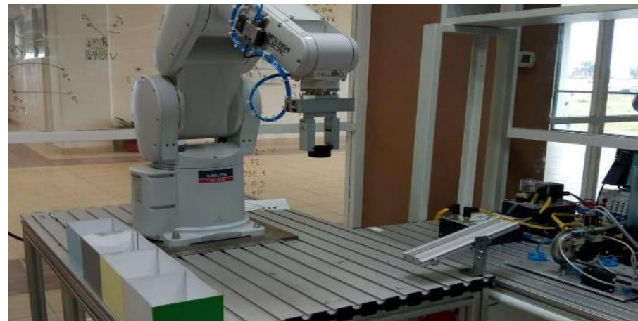
Figura 1. Selección de piezas de trabajo, en relación a su color en base a la pantalla HMI.
