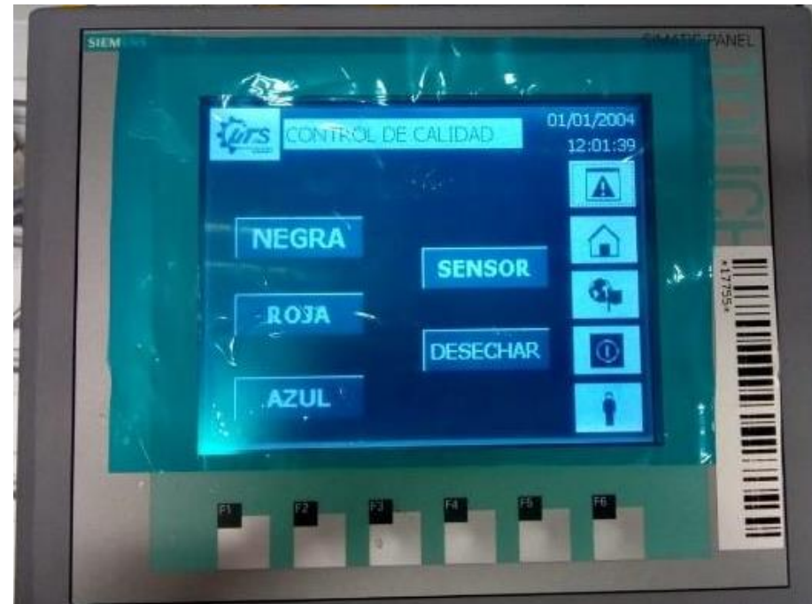
Figura 5. Pantalla HMI para el monitoreo de arranque del sensor y la variable detectada por el mismo. (izquierda) simulación, (derecha) implementación.
